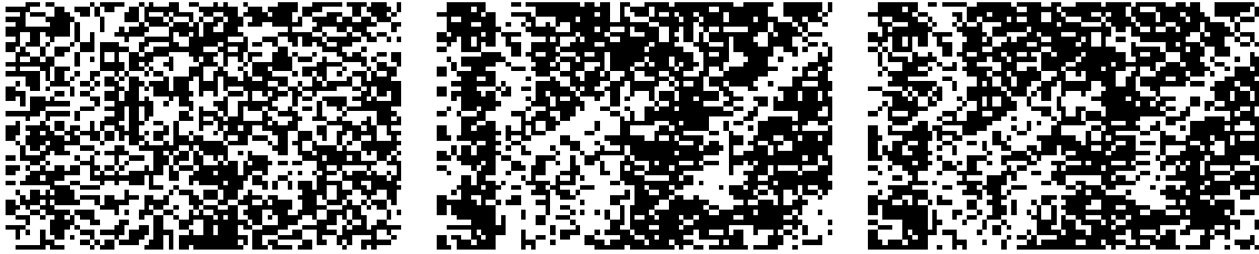
図 9: p = 300 , 初期状態を m(0) = (1/N)S(0) \cdot \xi^1 = 0.2 に選んだ場合の想起過程. 左から t = 0, 1, 12 の時刻での回路網の状態.
