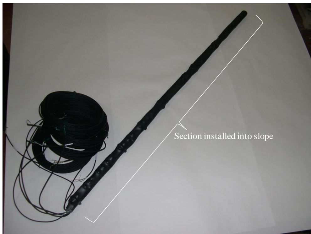
(d) Thermometers for soil temperature
