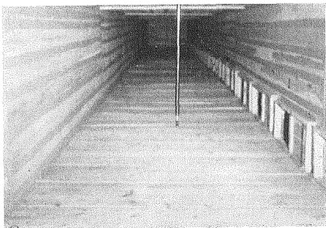
写真6-㉕ 同じく、ピトー管の挿入状況
