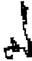
図 3.11 ランダムウォークモデルによる亀裂形成のシミュレーション
