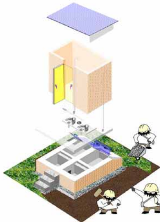
図-3 トイレの構造
