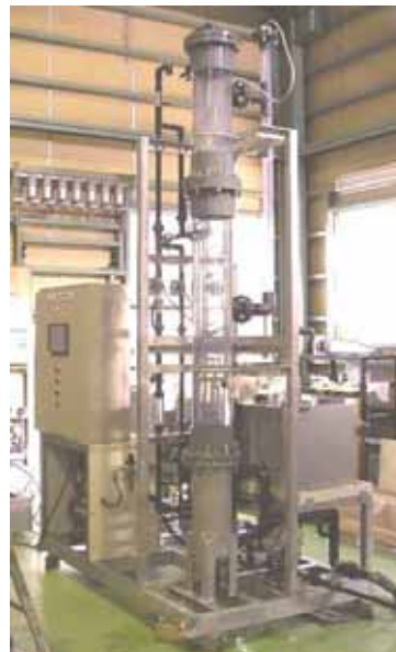
写真 2 2 段目膜ろ過装置外観
