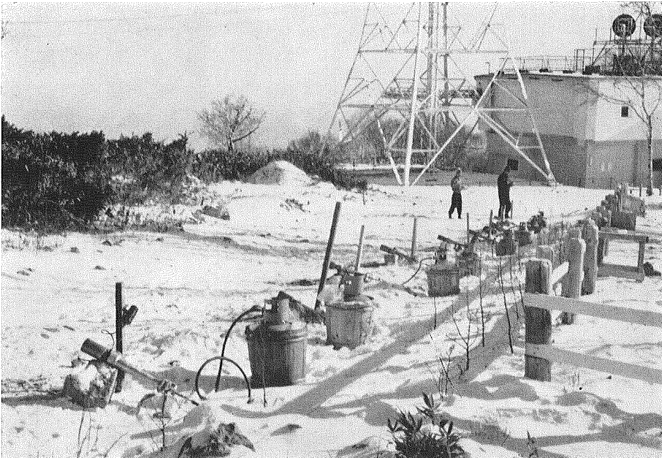
写真 2. プロパンガスバーナー燃焼試験
