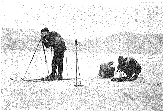
写真 3. くったら湖上における重力測定 (1966年3月)
