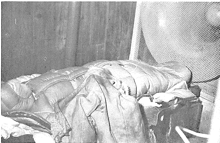
写真 3 低温室内風洞での寝袋の試験
