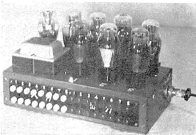
寫眞 3 真空管繼電器
