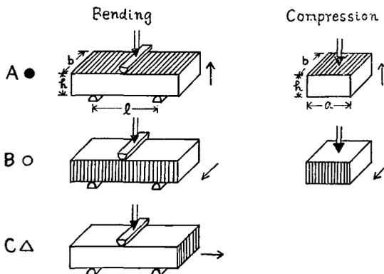
第2図 力の方向と試料の方向との関係による分類。
