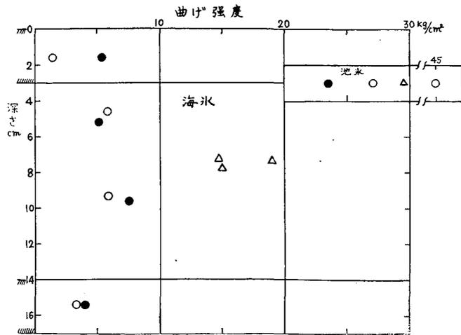
第6図 海水及び池水の曲げ強度
