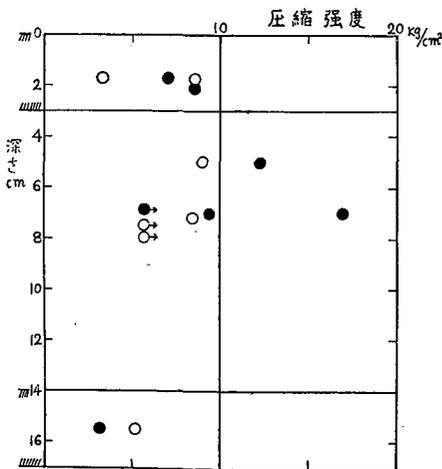
第7図 海水の圧縮強度
