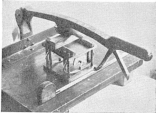
第1図 簡易圧縮・曲げ試験器。現在曲げ試験の用意がなされている。
