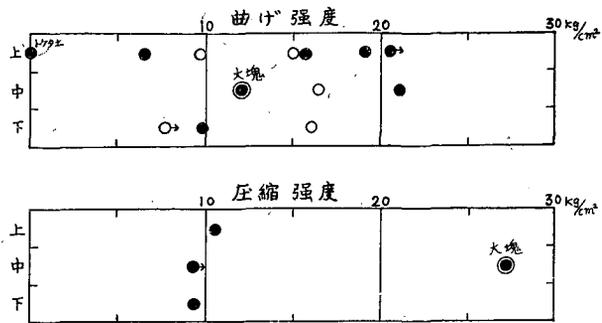
第3図 凍土の曲げ強度と圧縮強度
