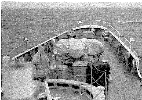
第 8 図 しぶき量測定状況 (巡視船“ちとせ”前甲板)
