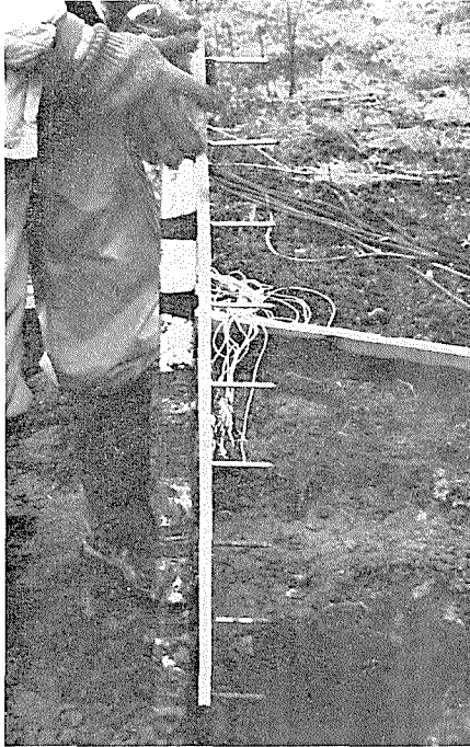
第1図 電気抵抗測定用の電極部分
