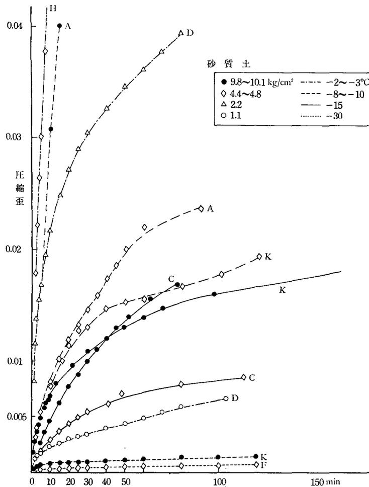
第3図 砂質土の圧縮歪一時間曲線。各曲線に付けた記号は試料記号を表わす
