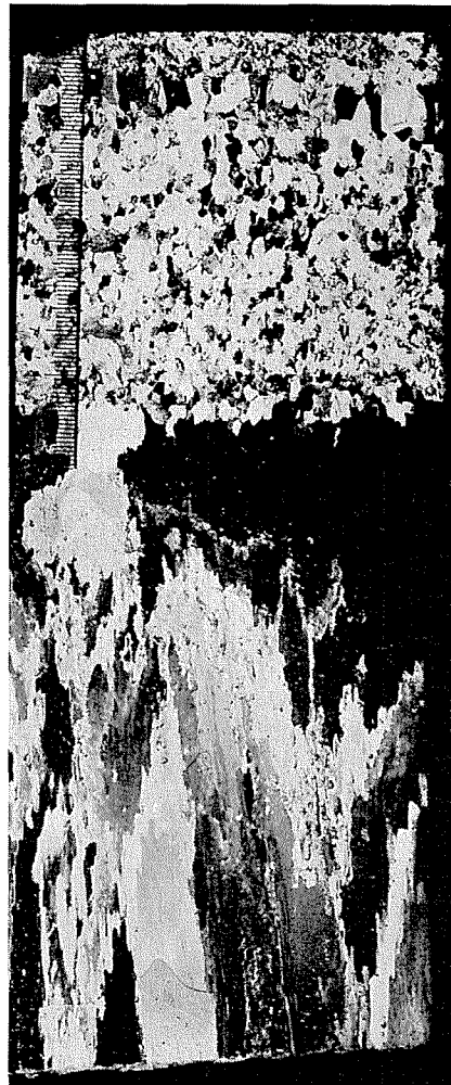
第2図 B点の氷の垂直断面の偏光写真
