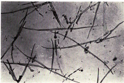
第9図 ヤマモミジ内皮繊維の顕微鏡写真 Fig. 9. Fiber of the inner bark of Acer palmatum var. Matsumurae (×37)
