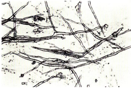
第13図 ヤチダモ内皮繊維の顕微鏡写真 Fig. 13. Fiber of the inner bark of Fraxinus mandshurica var. japonica (×37)
