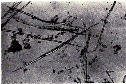
第5図 ホウノキ内皮繊維の顕微鏡写真 Fig. 5. Fiber of the inner bark of Magnolia obovata (×37)
