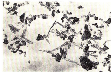
第24図 シラカンパ内皮繊維の顕微鏡写真 Fig. 24. Fiber of the inner bark of Betula platyphylla var. japonica (×37)
