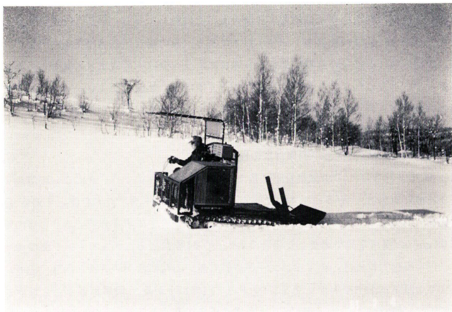
写真—1 開発された発電機付き小型集材車が深さ約94 cmの水平な自然積雪の上で走行している状況
