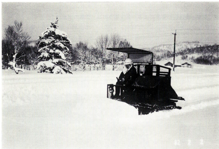
写真一六 改良された発電機付き小型集材車が深さ約 250 cm の水平な自然積雪の上で走行している状況
