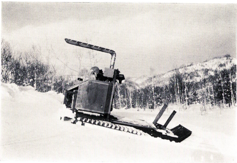
写真-2 開発された発電機付き小型集材車が自然積雪の上で登坂している状況
