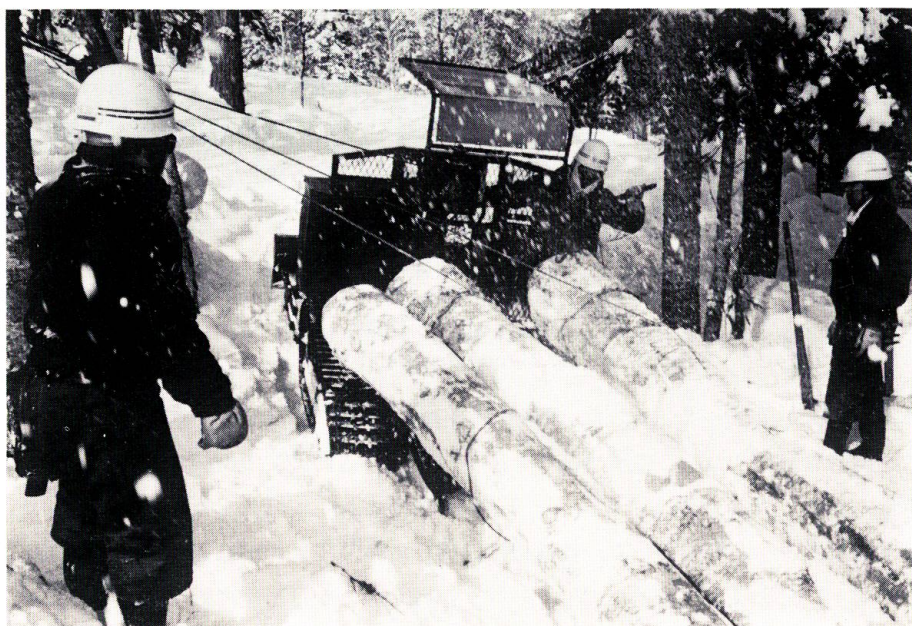
写真-7 改良された発電機付き小型集材車による集材の状況
