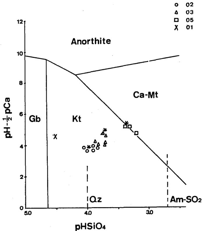
図—17 CaO-SiO<sub>2</sub>-Al<sub>2</sub>O<sub>3</sub>-H<sub>2</sub>O系の安定度図 (1979. 10. 19~11. 25)
