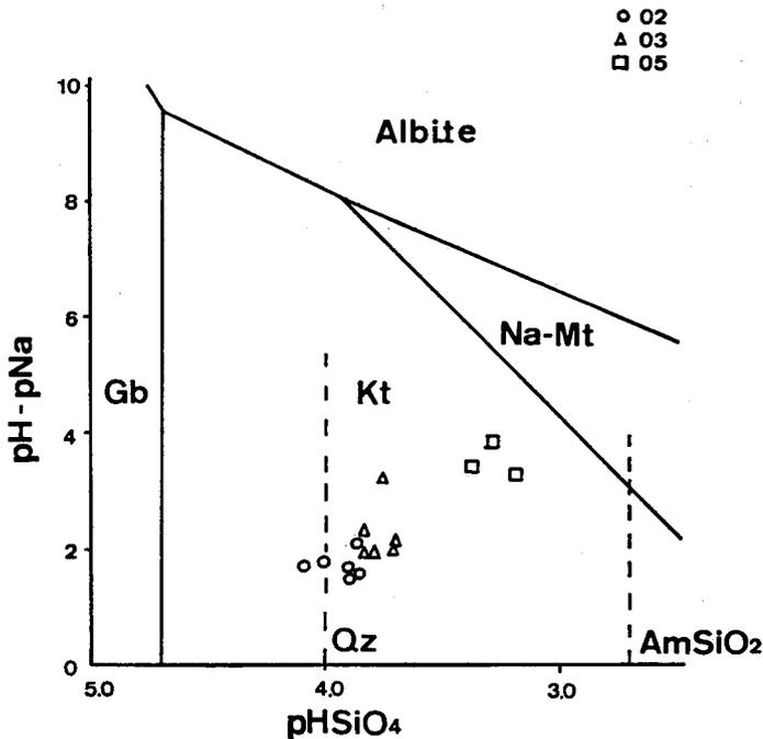
図-16 NaO-SiO<sub>2</sub>-Al<sub>2</sub>O<sub>3</sub>-H<sub>2</sub>O 系の安定度図 (1979. 10. 19~11. 25)
