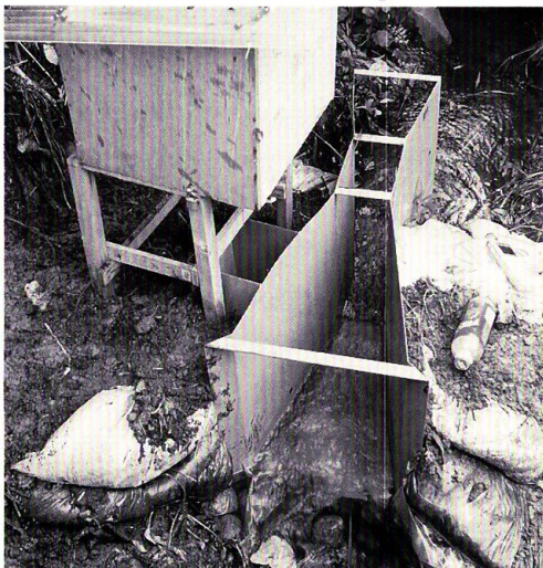
写真-7 流量観測状態 (平水時の例, Yt 流域) 手前が上流側。上流側の河床にはビニールシートを埋めこみ、漏水を防いでいる。またプラ波板のついた木箱の中に水位計が入っている。位置は図-2 参照。
