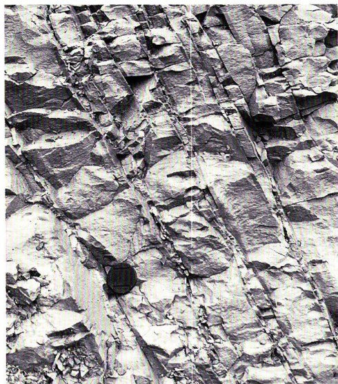
写真-1 Wk (稚内層) の層相 10 cm 程度の間隔で節理が入る頁岩である。 位置は図-2 参照。
