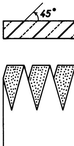
図1 45度傾斜フィンガージョイント
