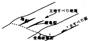
圧縮変形に伴う分離破壊による縦亀裂 (せん断破壊による隆起を伴う)
