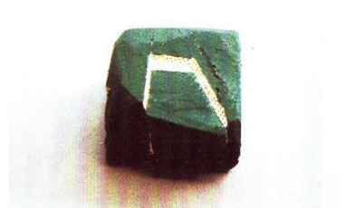
写真-VI-2(3) 地すべり発生後
