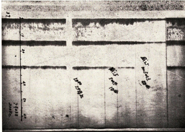
Fig. 25. Soner echo due to current rip
