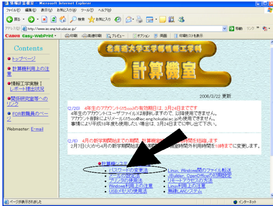
図 2: Netscape ブラウザで計算機室のホームページを立ち上げ、矢印の部分をクリックして、パスワード変更ツール：スルー PASS4.2 の画面に入る。
