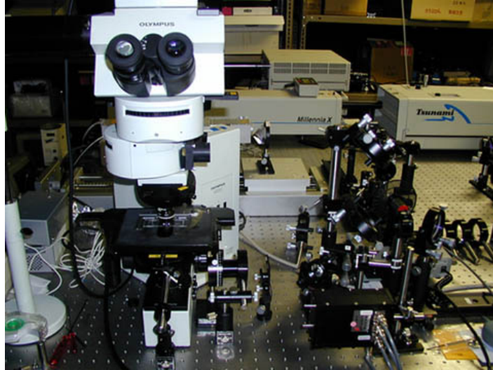
図 3 - 4 微分干渉吸収分光システムの写真 顕微鏡部分にノマルスキープリズムが組み込まれている
