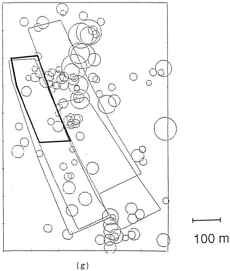
図 6. 3 0 布引 8 片 5 層 ロング 採掘 時 の 震 央 分 布 、 (g) 1986 年 2 月 1 日 ~ 1986 年 6 月 30 日 )
