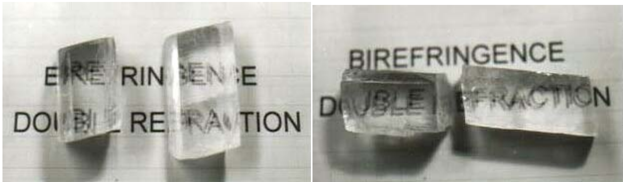
図 2.2 単軸結晶を通して見たときの文字の見え方 (複屈折) (a) (b)
