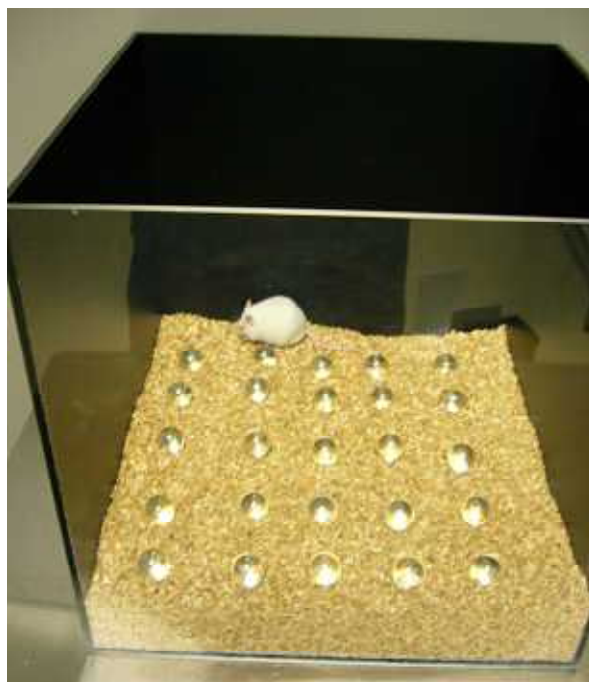
図 6. ガラス玉覆い隠し試験装置
