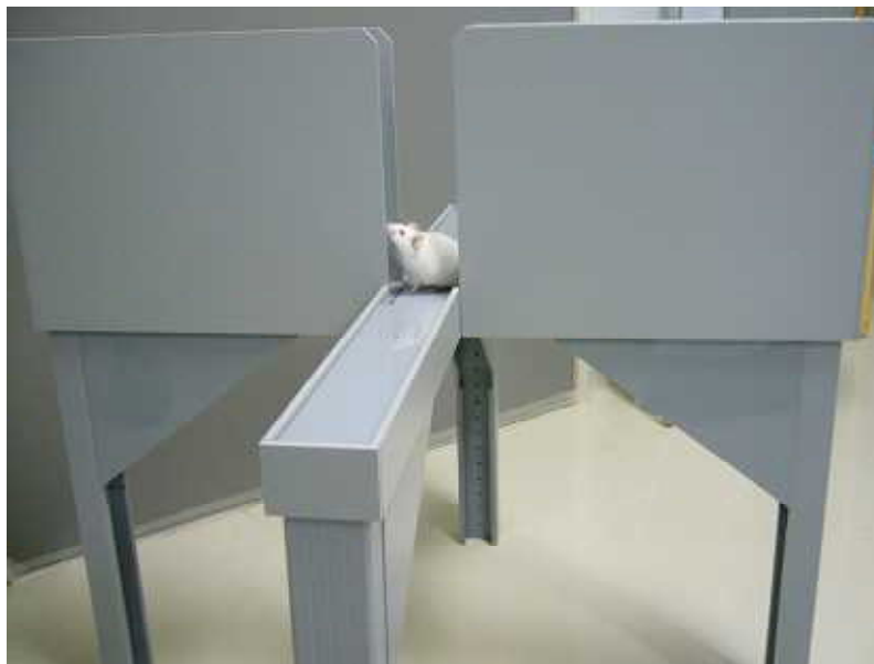
図 4. 高架式十字迷路試験装置
