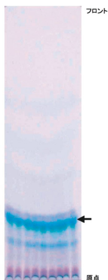
図4：メタノリシスで抽出したビリジ色素の薄層クロマトグラフィーによる分離例。矢印はフィコシアノビリジンを示す。
