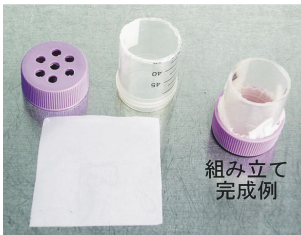
図1: ゼニゴケ幼葉状体の回収洗浄用器具 切断した 50 ml プラスチックコニカルチューブ, 穴を開けた蓋と 6×6 cm に切った 50 µm 格子ナイロンメンブレンを, 右にあるように組み立てる。
