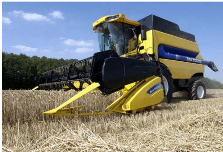
Fig. 6-23. Combine Harvester (New Holland, CS-540).
