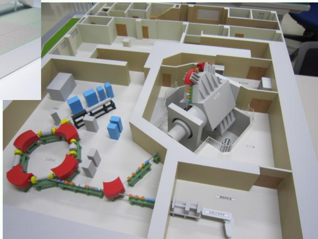
北海道大学分子追跡 陽子線治療施設 建屋内部(加速器、回転ガントリ)
