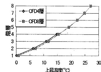
図10 8層積層設置シミュレーションによる各層吸込み口温度上昇
