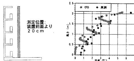
図8 CFDと実測の屋外温度比較(左図測定位置)
