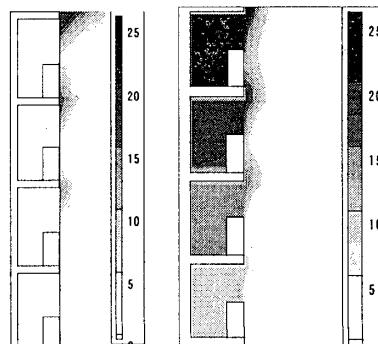
図6 実験(左)とシミュレーション(右)による温度分布図
