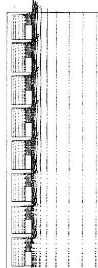
図12 8層積層設置時の風速ベクトル図
