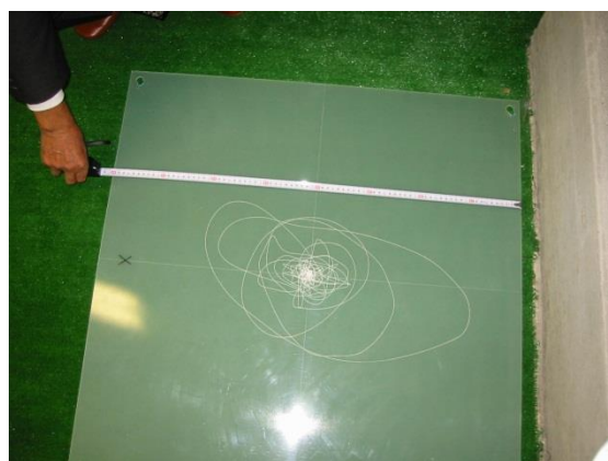
(b) けがき針変位計に記録された 変位オービット
