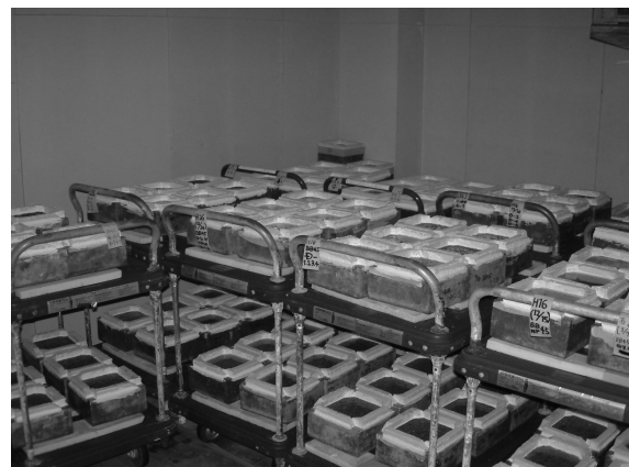
写真-2.2.2 低温室に収納されている供試体
