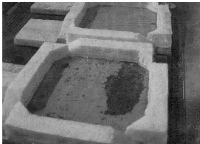
写真-6.3.2 吸水防止層の崩壊（実験中に撮影）
