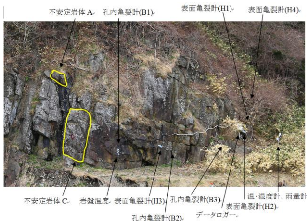
図1 計測対象の岩盤と計測装置の様子
