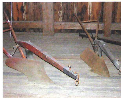
博物館用として1887年に輸入されたプラウ 左: Chilled Plow (Deere社) 右: Hill-side Plow (Knapp社)
