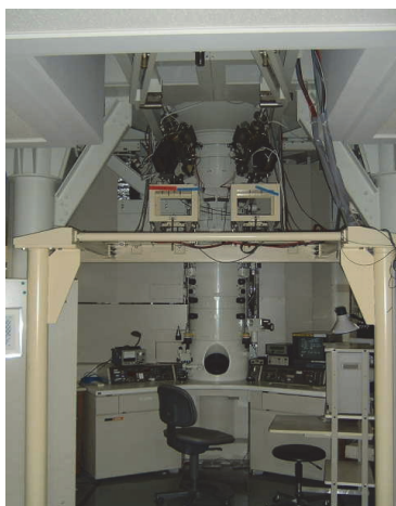
図 3-11 超高压超高分解能電子顕微鏡(JEM-ARM1300)の外観。
