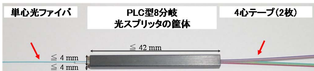
図 2-5 PLC 型 8 分岐光スプリッタ
