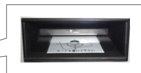
設置された ICカードリーダー
