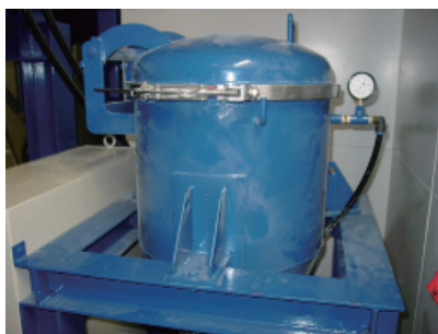
写真3-2 粉体供給装置のタンク
