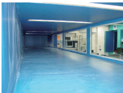
写真3-1 風洞装置測定部
