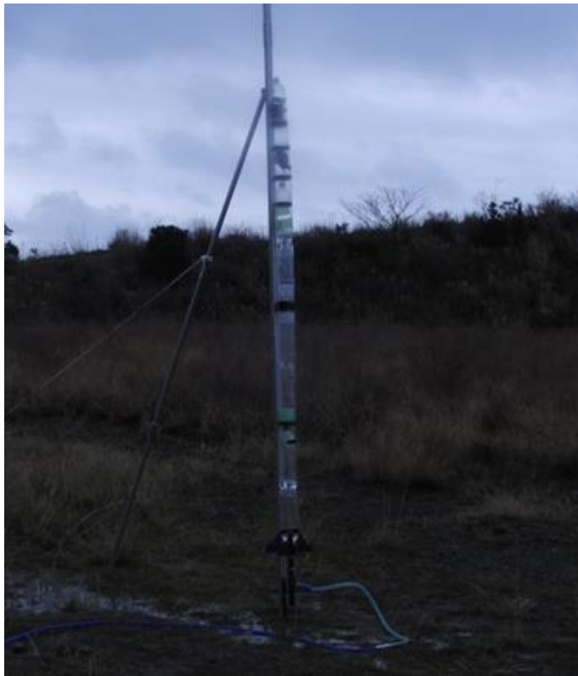
発射台に据え付けられた 大型ペットボトルロケット
