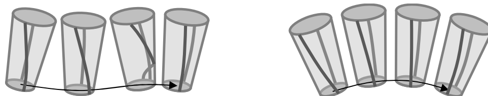
(a) 一つの工具パスで工具掃引形状が変化 (b) 一つの工具パスで工具掃引形状が一定
