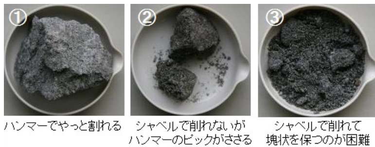
写真1 変状トンネルの補修時に採取した試料
