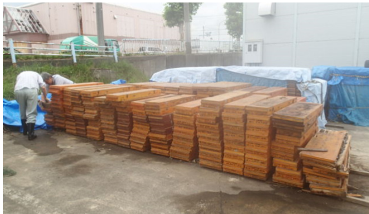
写真3 屋外でのコアの保管状況
