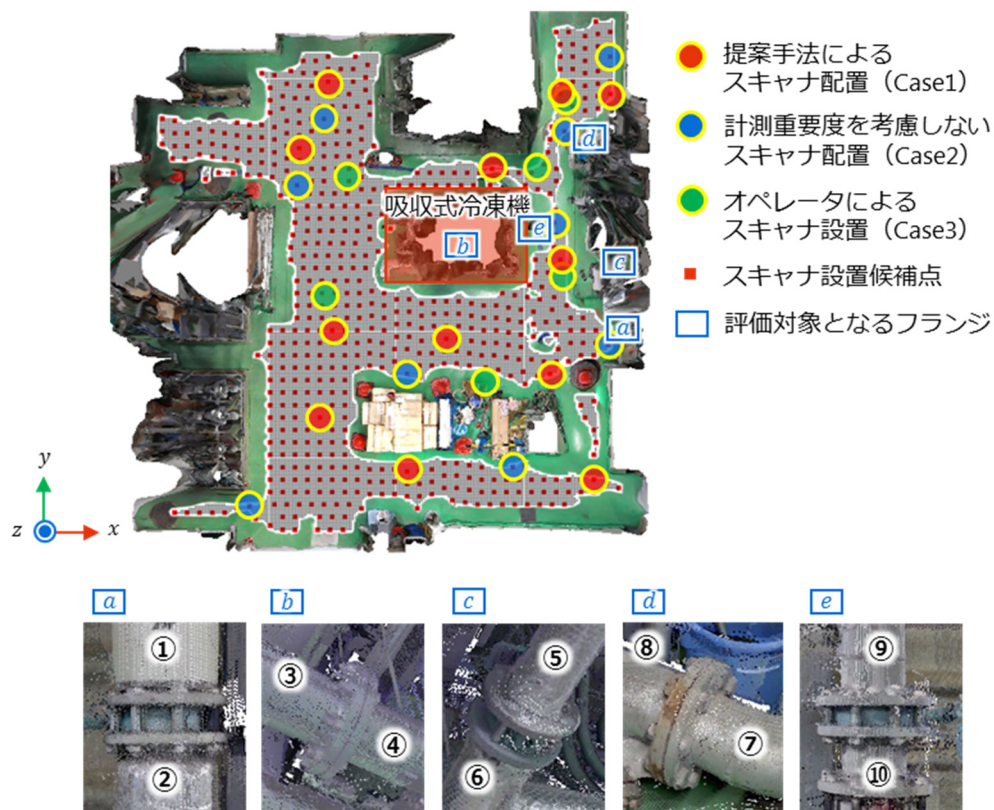
図 2.62 各ケースのスカナ設置位置分布と評価対象となるフランジ
