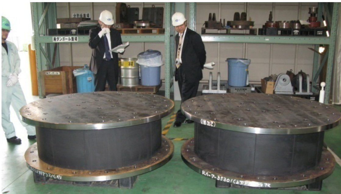
写真 2.1 外径 1300mm の積層ゴム試験体 RB1300 (6.4)
