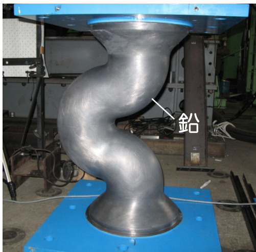
写真 1.1 免震用鉛ダンパー
