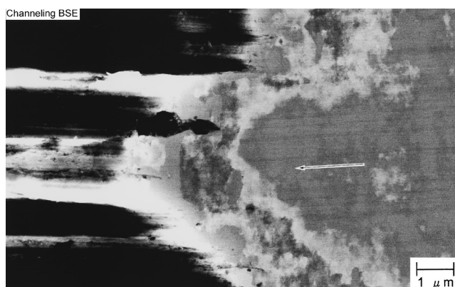
図5 高圧 Al 電解コンデンサ用 Al 箔表面組織の channeling BSE 像
