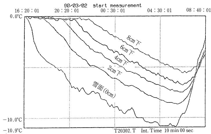
図-2 各深さでの雪温の时间変化(3/2~3)
