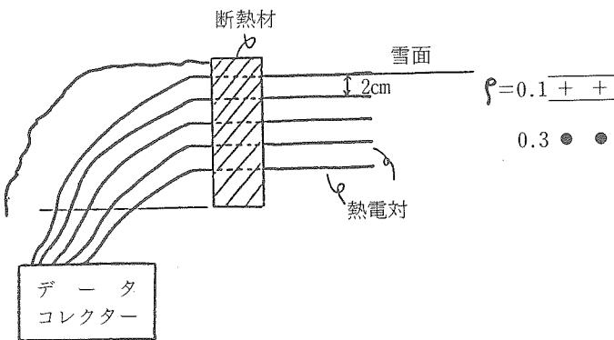
図-1 雪温測定法と層構造(3/2)
