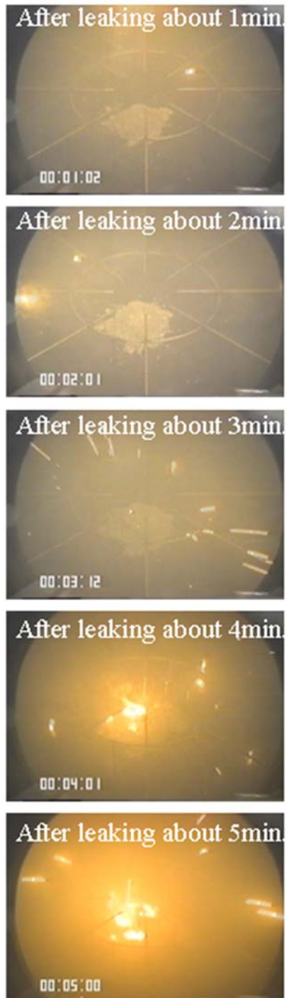
図 3- 14 漏えい初期のカメラ映像 (Case1)
