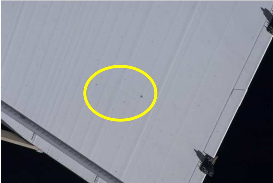
Fig. 2 国際宇宙ステーションのラジエーターパネルに開いた穴
