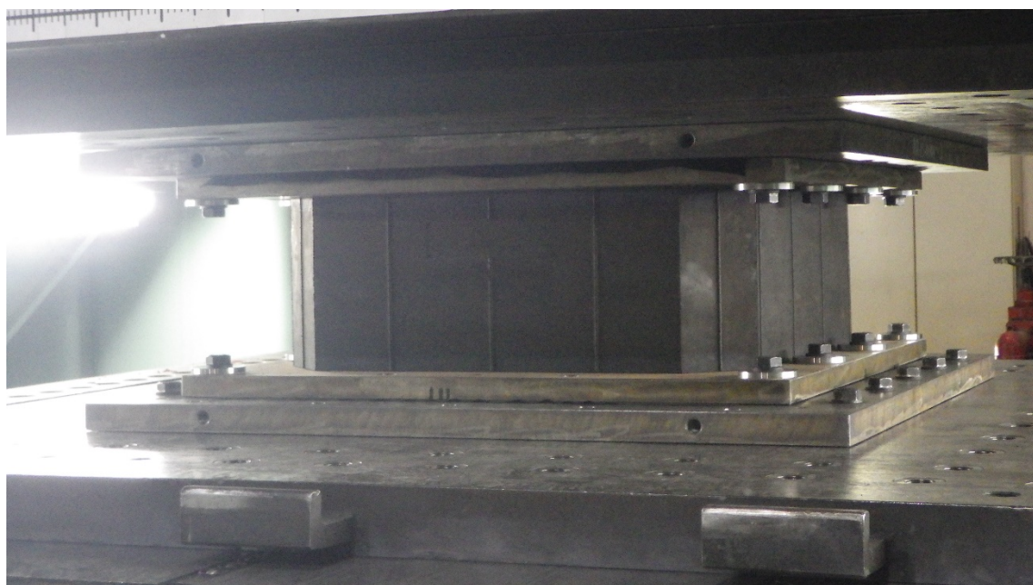
写真 2.7 マルチプラグ LRB 試験体, および 40MN 二軸試験機への試験体取付状況
