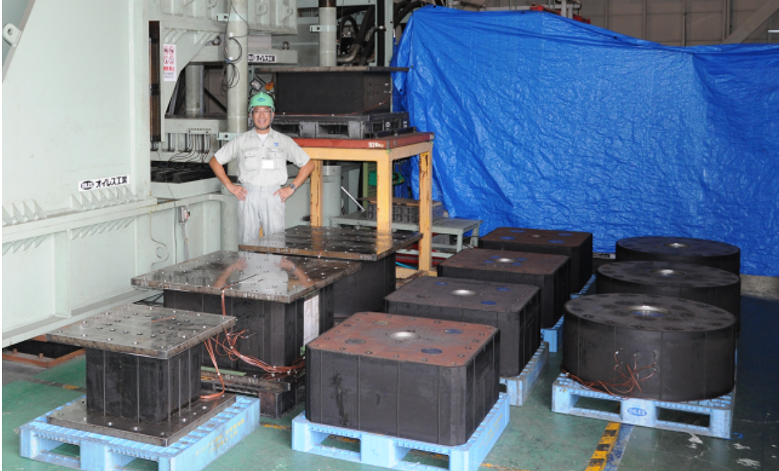
写真 4.1 3MN 二軸試験機と LRB 試験体
